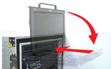
Встроенный монитор TLM-170 выдвигается из полки
