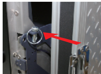
Замки крепления пульта микшера SE-900 для защиты от повреждений при транспортировке.
